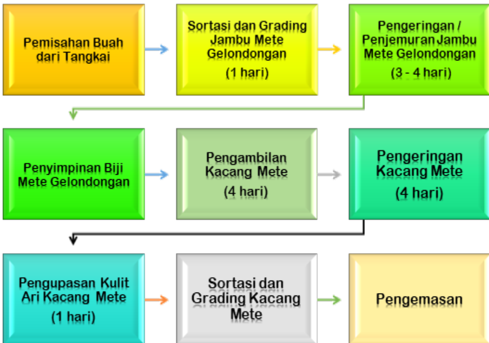
Gambar 12. Alur Proses Pengolahan Mete di Tingkat Rumahtangga
